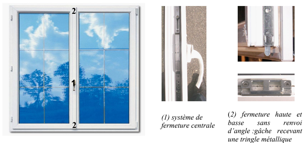
Figure 26 : système de fermeture classique à crémone 3 points avec sortie de tringle (sans renvoi d'angle) d'une fenêtre à ouverture à la française
