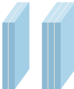
Figure 8 : schéma d'un vitrage simple feuilleté de type 44.2 (à gauche) et 666.4 (à droite)
